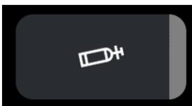
Hier wird das Gasventil im Gerät geöffnet. Diese Funktion wird verwendet, um den Gasdurchfluss am Durchflussregler korrekt einstellen zu können (Empfohlener Gasdurchfluss 2-3 l/min).
